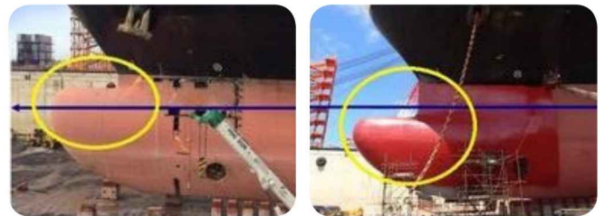
▲ 改造前 ▲ 改造後 バルバスバウの改造（船型や運航条件に併せてバルバスバウの形を改造）
