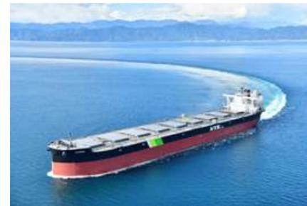
LNG燃料ケーブサイズドライバルク船「SG OCEAN」
