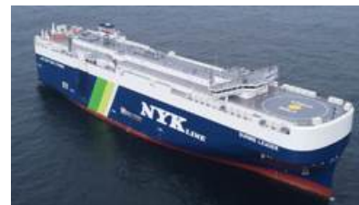
当社運航船として6隻目のLNG燃料自動車専用船「SUMIRE LEADER」
