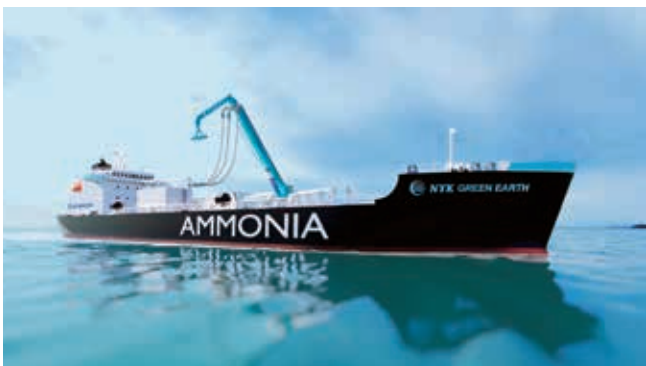
アンモニア用バンカリングブーム(船舶間のアンモニア燃料供給設備)の3Dモデル。安全な燃料供給のため、漏洩対策に向けた開発を進めます
