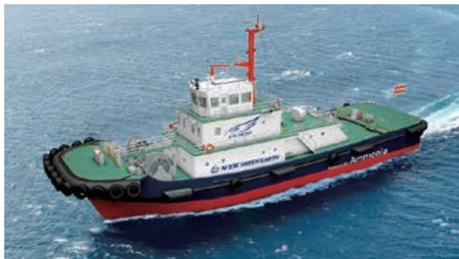
A-Tugのイメージ。LNG燃料タグボートとして活躍した、当社が保有し当社グループの株新日本海洋社が運航する「魁」をアンモニア燃料船に改造します
