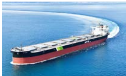
LNG燃料ケーブルサイズバルカー「SG OCEAN」(LNG二元燃料エンジン搭載船)
