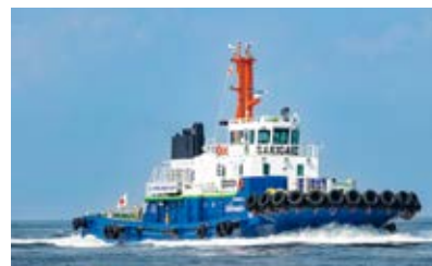
LNG燃料タグボート「魁」を改造した アンモニア燃料タグボート
