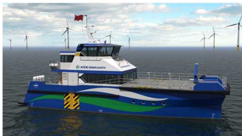
左：CTV（Crew Transfer Vessel：作業員輸送船） 右：SEP船（Self-Elevated Platform船：自己昇降式作業船）
