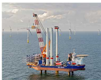
左：CTV（Crew Transfer Vessel：作業員輸送船） 右：SEP船（Self-Elevated Platform船：自己昇降式作業船）
