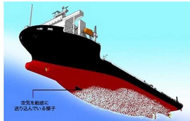
本システムを搭載したモジュール運搬船を下から見たイメージ図
