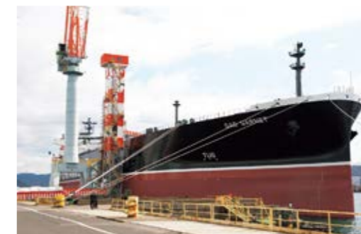
アンモニアも積載可能なLPG運搬船「GAS GARNET」(LPG二元燃料エンジン搭載船)
