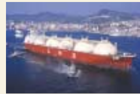
LNG船 船名:「アル ジャスラ」 全長 / 297.50m 総トン数 / 111,168t タンク容量 / 135,168.93m³ 竣工 / 2000年7月
